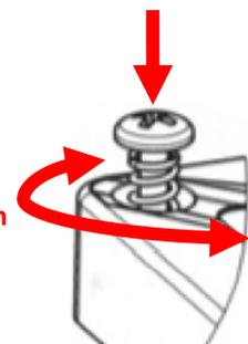
Anzugsdrehmoment für die Gehäusebefestigung: **max. 3 Nm !**
