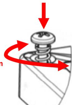
Anzugsdrehmoment für die Gehäusebefestigung: **max. 3 Nm !**
